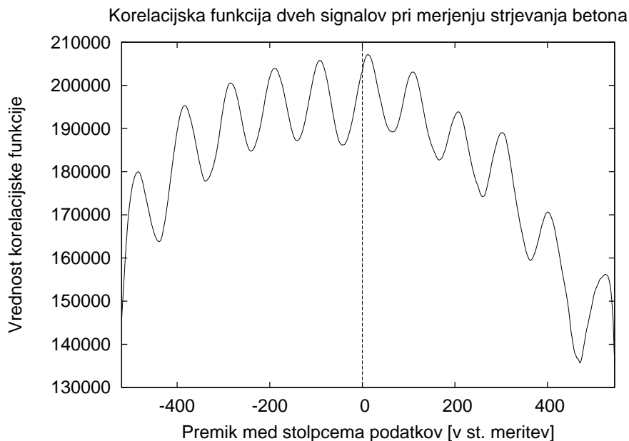
Slika 3: Korelacijska funkcija strjevanja betona za dve točki (v notranjosti in tik pod površino bloka). Korelacijska funkcija je narisana za primer, ko prvi signal premikamo po drugem in računamo korelacijski koeficient in nato še če drug signal pomikamo po prvem.
